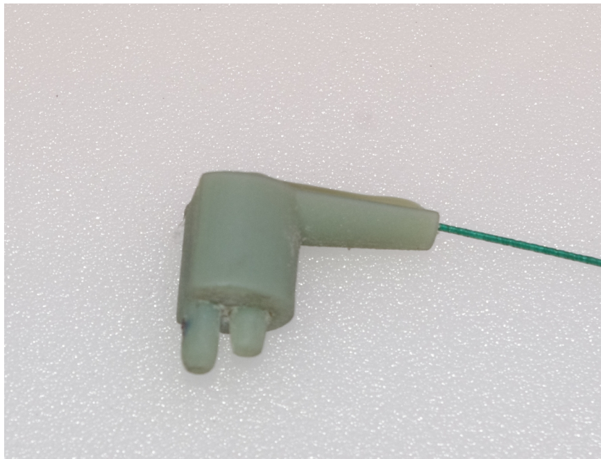
Slika 23. Sonda za mjerenje temperature kortikalne kosti zasnovana na termoparu K tipa
