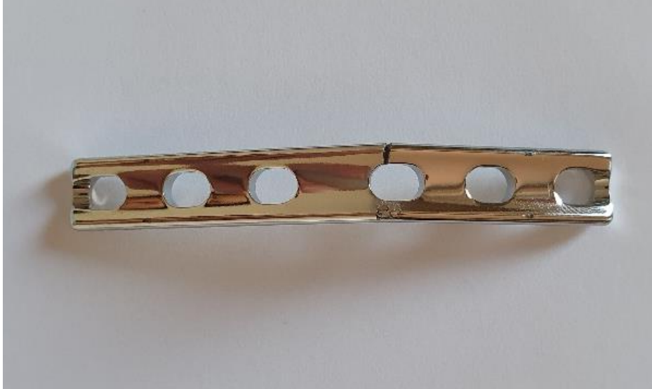
Slika 57. Ista pločica broj 42 prikazana straga (kontrolna skupina) po puknuću uslijed cikličkog testiranja; zorno se prikazuje mjesto loma u području otvora pločice najbližoj mjestu primjene opterećenja
