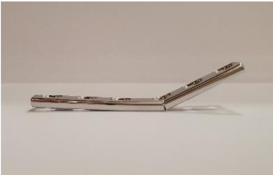
Slika 56. Pločica broj 42 iz četvrte skupine prikazana sa strane (kontrolna skupina) po puknuću uslijed cikličkog opterećenja
