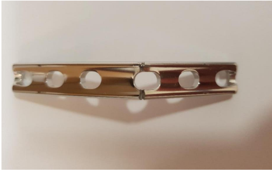
Slika 55. Ista pločica broj 33 prikazana straga (pH 5,0) po puknuću uslijed cikličkog testiranja; zorno se prikazuje mjesto loma u području otvora pločice najbližoj mjestu primjene opterećenja
