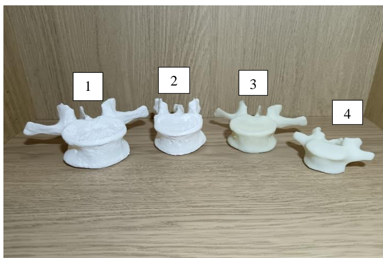
Slika 10. Prikaz 3D tiskanih kralježaka koje je izradila studentska Sekcija za inovacije pri Medicinskom fakultetu u Zagrebu. Brojevima 1 i 2 označeni su modeli kralježaka otisnuti FDM metodom, a brojevima 3 i 4 označeni su modeli kralježaka otisnuti SLA metodom.
