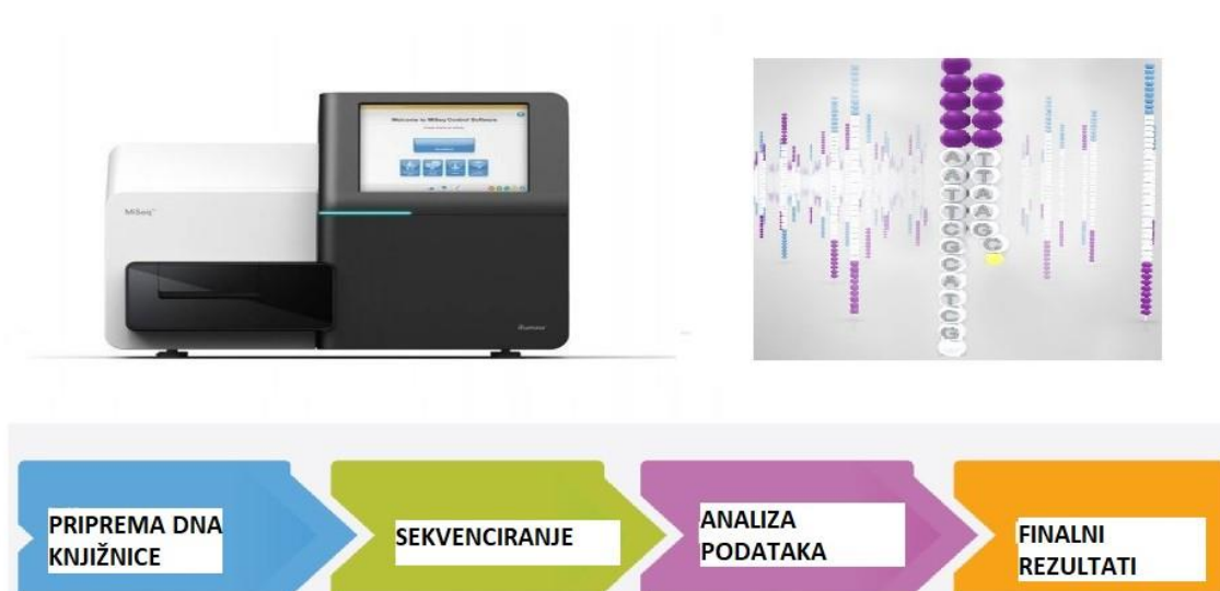
Slika 11. Illumina MiSeq i osnovni koraci u sekvenciranju
