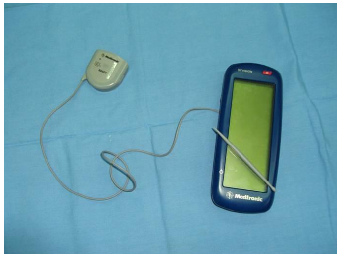
Slika 5. Uređaj za programiranje DBS-a koji se koristi postoperativno (ljubaznošću Fadi Almahariq, dr.med./ Zavod za neurokirurgiju Kliničkog bolničkog centra Dubrava)
