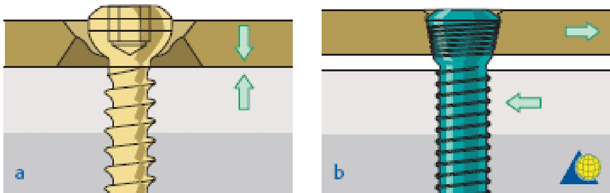
Slika 7. a) Konvencionalni pločica i vijak: vijak pritišće pločicu te oštećuje periost i cirkulaciju, b) pločica i vijak koji se zaključava: zaključana glavica vijka stabilizira pločicu, no nema pritiska na kost te su periost i cirkulacija sačuvani. Prema: Rüedi et al, AO Principles of Fracture Management, Thieme, Stuttgart, 2007.
