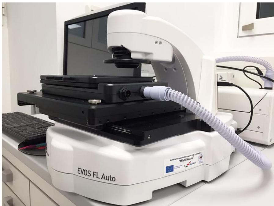
**Slika 1.** Prikaz EVOS mikroskopa za automatsko slikanje visokom rezolucijom.
