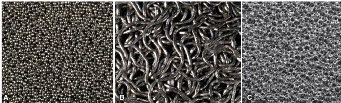
Slika 4.6 Tipovi površina koje omogućuju uraštanje kosti. Tradicionalne površine (A i B) te novija visoko porozna tantalna površina, nalik je na trabekularnu strukturu kosti (C).
