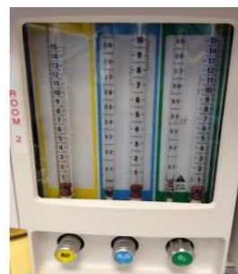
Mjerač protoka kalibrirana je stožasta staklena cjevčica u kojoj indikatorski plovak ili loptica pluta kako bi pokazali protok plina. Elektronički mjerač protoka omogućuje očitavanje na zaslonu.
