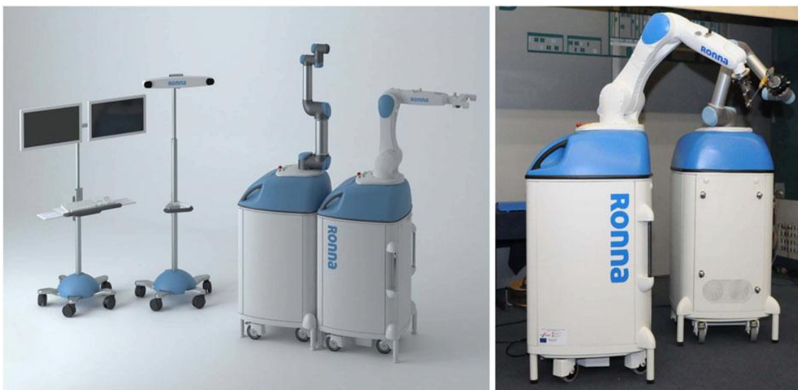
Slika 21. RONNA G3 robotski neuronavigacijski sustav. Preuzeto iz Dlaka i sur. 2018., dorađeno za potrebe diplomskog rada
