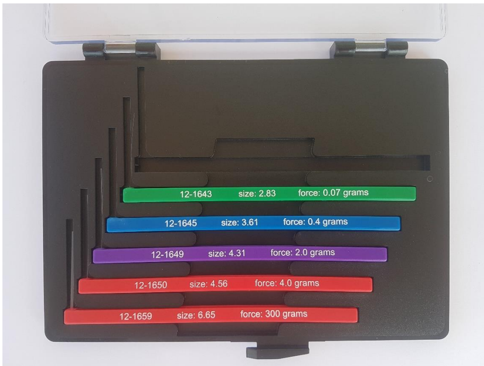
Slika 3. Set od pet Semmes-Weinstein monofilamenata za kvantitativno ispitivanje osjeta dodira
