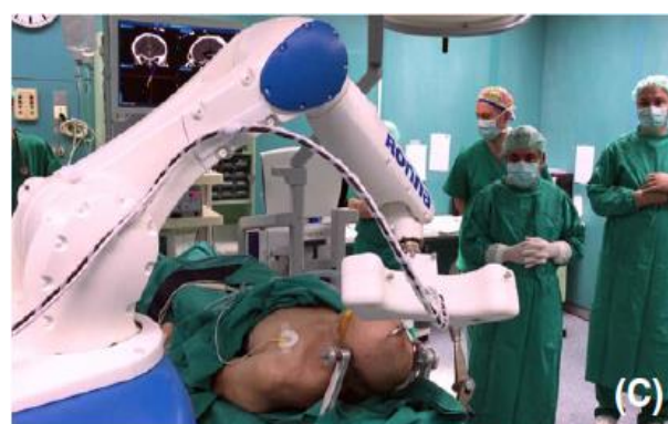
Slika 6. RONNA stereotaksijska biopsija. A, pacijent se snima kompjuterskom tomografijom; rigidni marker je pričvršćen za lubanju. B, provjera plana operativnog zahvata u operacijskoj sali. C, fiksacija pacijentove glave za držač; robot je pozicioniran uz glavu i lokalizira pacijenta. (Preuzeto iz (10))
