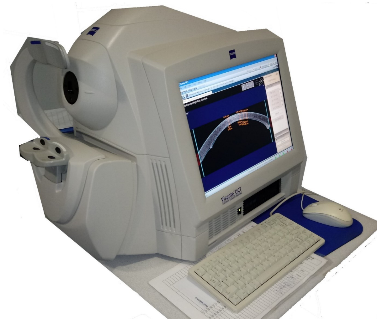
Slika 8. Uređaj za mjerenje debljine lamele, okularni tomograf za prednji segment (engl. A-OCT – anterior segment ocular tomography) Visante A-OCT (Carl Zeiss Meditec, Jena, Germany).
