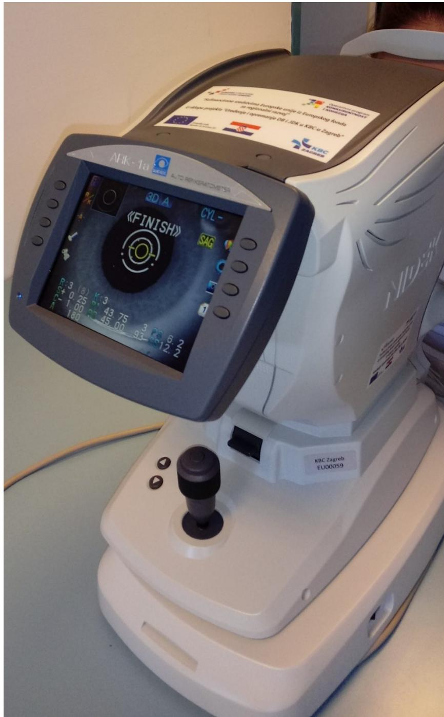
Slika 4. Za lakše određivanje vidne oštrine koristi se automatski refraktometar (Nidek Auto Refractometer ARK 1a, Nidek CO. LTD. Japan).
