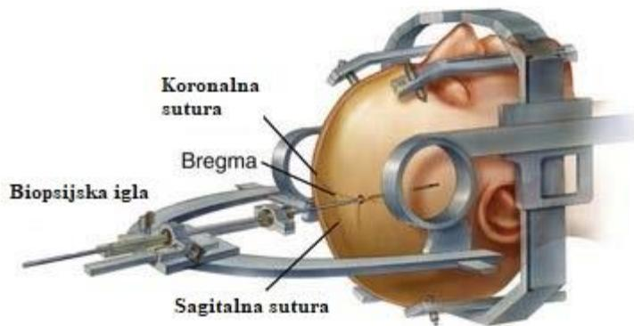
**Slika 6.** Prikaz predoperativno postavljenog *Leksellovog* okvira i na njega pričvršćenog semicirkularnog luka kojim se može manipulirati vertikalno i anteriorno-posteriorno za postavljanje položaja koji je usmjeren k cilijnoj regiji (preuzeto iz Amundson, McGirt i Olivi, 2005; dorađeno za potrebe rada).
