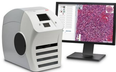
Slika 2.3: Moderni skener s integriranim mikroskopom i kamerom (10).
