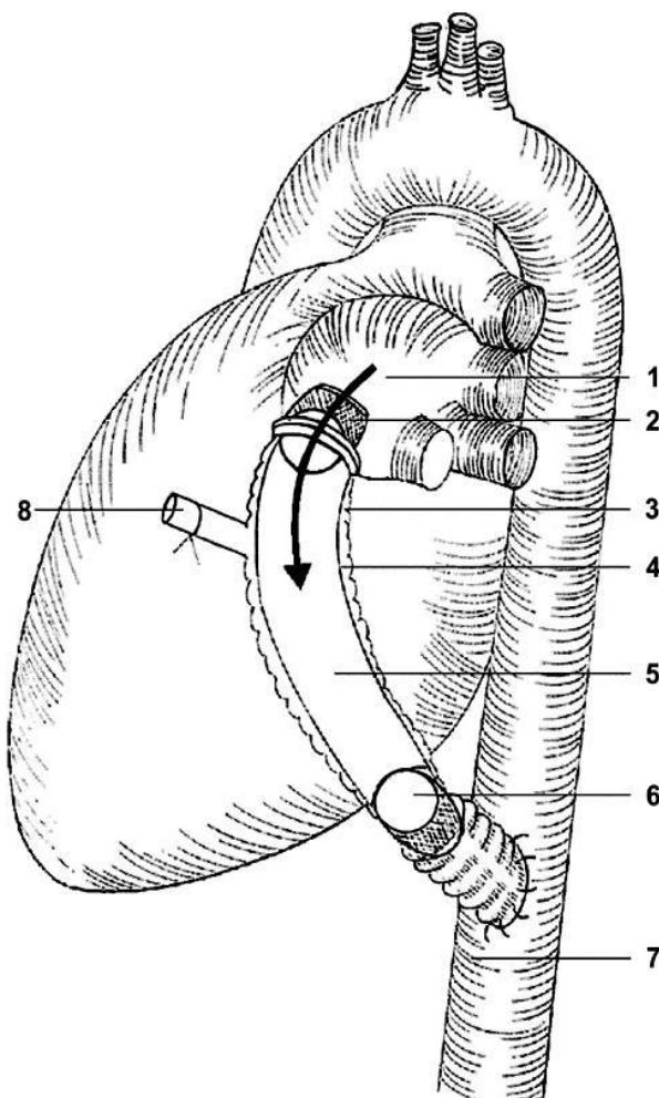
Slika 1. Crtež prototipa iz 1963. godine koji je razvio Domingo Liotta pri Sveučilištu Baylor, Houston. Srce je prikazano tijekom dijastole. 1 - lijevi atrij, 2 - ulazni ventil, 3 - kućište Silastica pojačano sa Dacron tkaninom, 4 - komora za zrak, 5 - komora za krv, 6 - izlazni ventil, 7 - silazna aorta, 8 - plastična cijev. Prema: Liotta (2002), uz dopuštenje Texas Heart Institute Journal.
