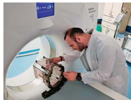
Medicinski fizičar pozicionira fantom s radiokromskim detektorom u CT uređaj
