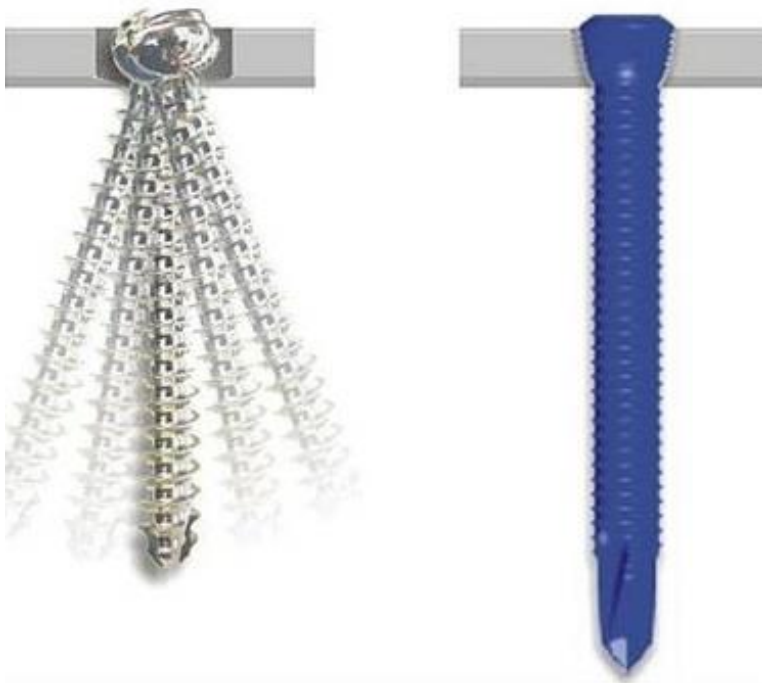
Slika 6. Preuzeto iz PowerPoint prezentacije „Basic principles and techniques of internal fixation of fractures“, Leo A. Calafi, MD, ožujak 2014. Shematska usporedba konvencionalnog i Locking-Head vijka.
