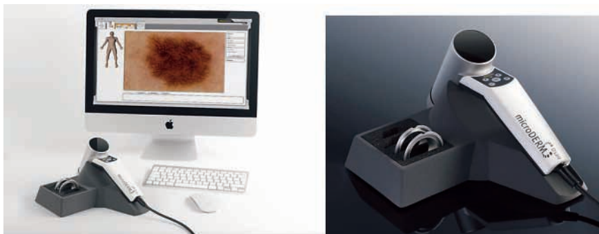
Uređaj i kamera za dermoskopiju sa softverskom analizom podataka.
