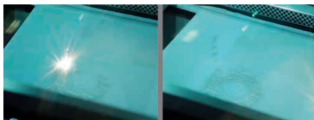
Komora titanskog SLS printera tijekom postupka izrade personaliziranog implantata zdjelice.
