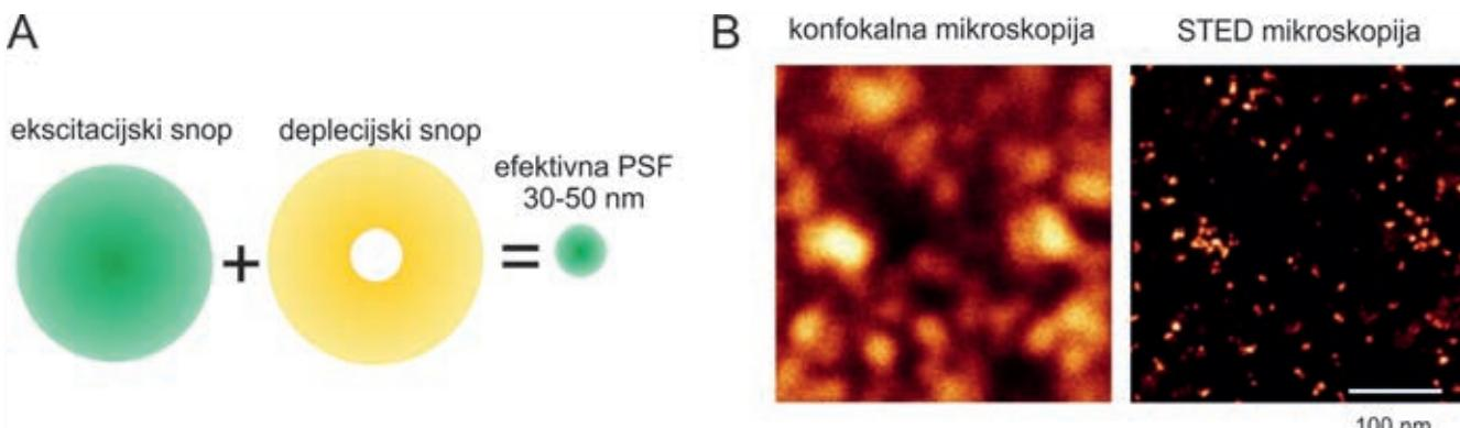
Slika 1. (A) Princip prostornog ograničenja funkcije rasapa točke (PSF) u STED mikroskopiji; (B) Usporedba slika fluorescentno obilježenih kompleksa jezgrinih pora dobivenih konvencionalnom konfokalnom i STED mikroskopijom.
