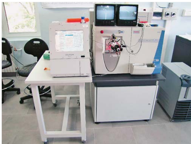
Odjel za proteomiku. Na slici lijevo je uređaj Orbitrap s nano-HPLC sustavom.
