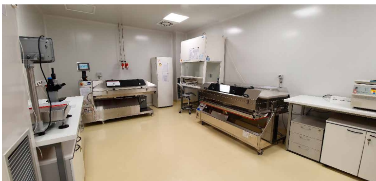
Slika 2. Laboratorij za rast stanica, klasa C. Reaktori za uzgoj stanica u 100 L vrećama medija bez animalnog seruma i antibiotika.
