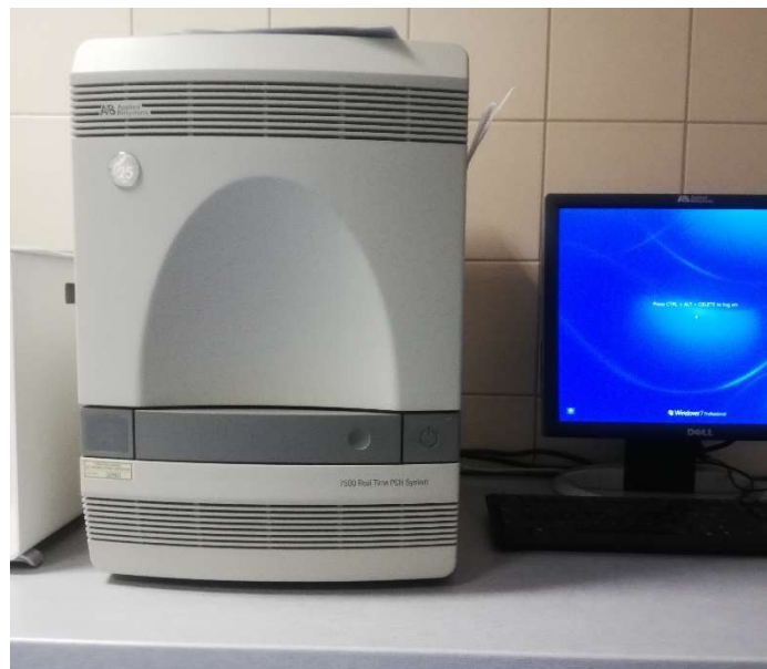
Slika 7. Uređaj 7500 Real Time PCR System (Applied Biosystems) za RHD probir (slikano u HZTM)
