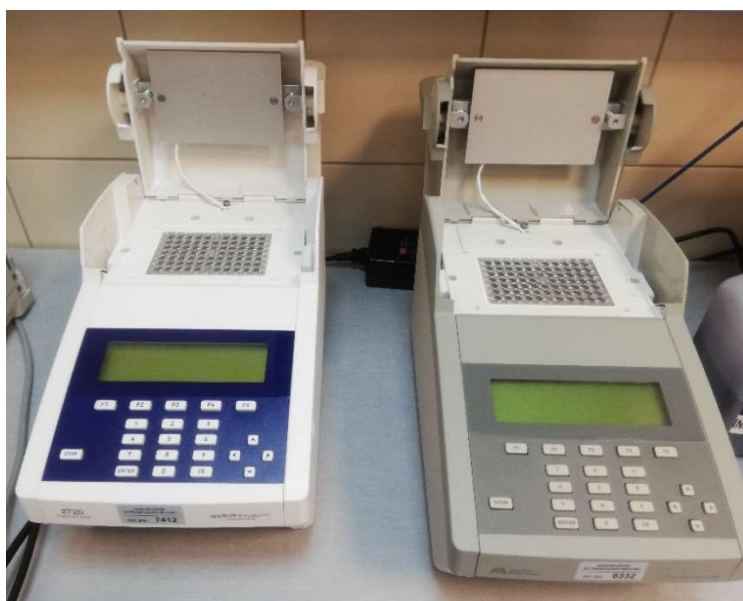
Slika 8. Uređaji AB PCR 2720 i 2700, thermal cycler (Applied Biosystems, SAD) za PCR-SSP genotipizaciju (slikano u HZTM)
