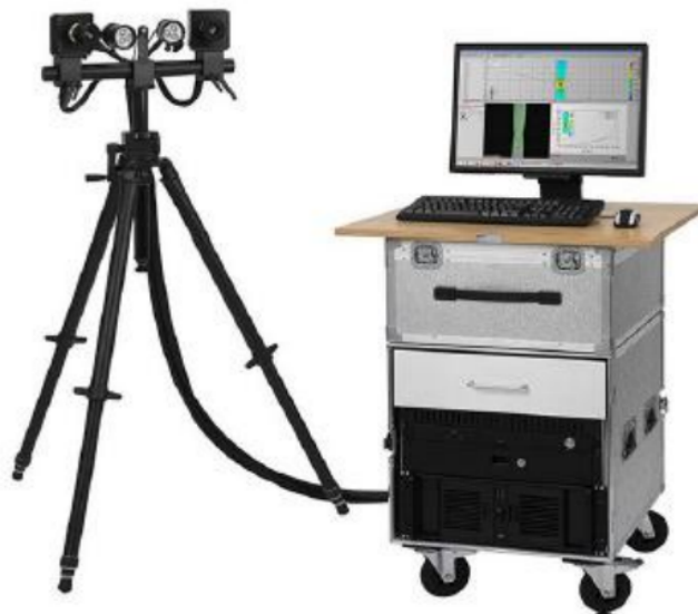
Slika 28. Optički mjerni sustav Aramis 4M (98)
