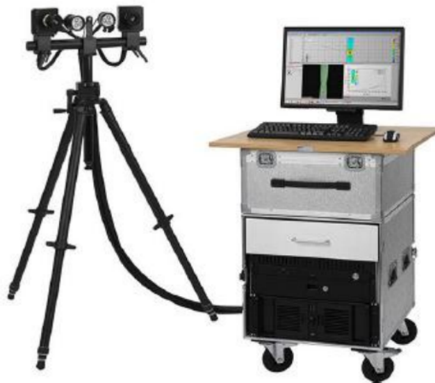
Slika 28. Optički mjerni sustav Aramis 4M (98)
