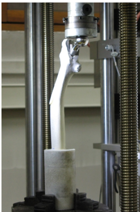
Slika 56. Velika deformacija uzorka u trenutku periprostetičkoga prijeloma
