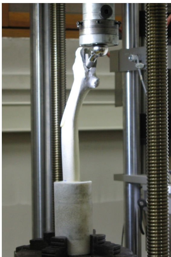
Slika 56. Velika deformacija uzorka u trenutku periprostetičkoga prijeloma
