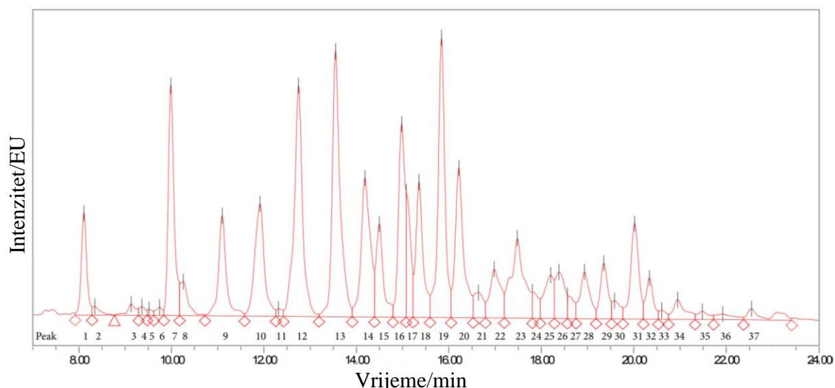
**Slika 20. Reprezentativni prikaz kromatograma N-glikana izoliranih s ukupnih proteina sjemene plazme.** Kromatogram je dobiven nakon provedbe tekućinske kromatografije ultra visoke djelotvornosti, temeljenoj na hidrofilnim interakcijama (HILIC-UPLC), sastoji se od 37 individualnih N-glikanskih pikova čiji intenzitet je prikazan u jedinicama EU (engl. *emission units*).
