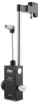
**Slika 3:** Goldmannov aplanacijski tonometar
