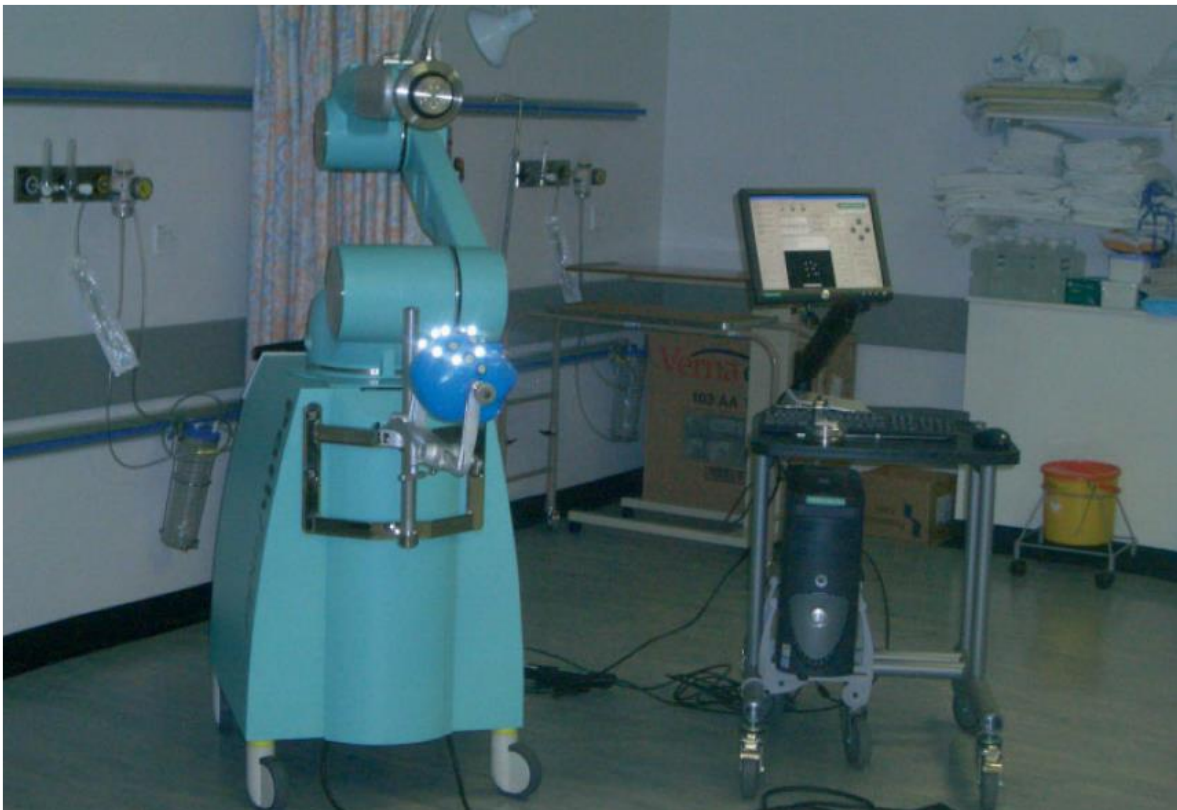
Slika 3. PathFinder robotski sustav. Preuzeto iz: Eljamel, 2006. (26) Uz dopuštenje John Wiley and Sons.
