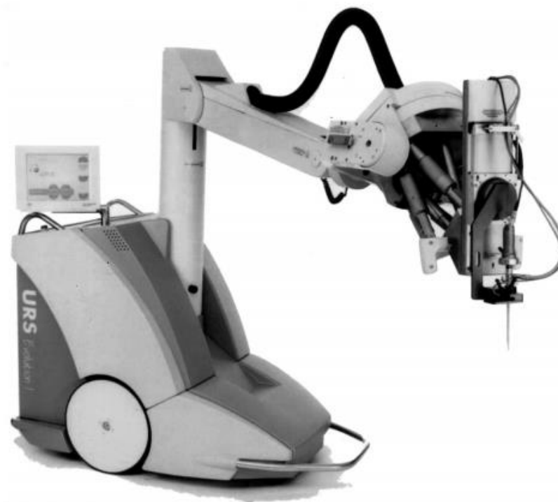
Slika 11. Neuroendoskopski robot Evolution 1. Preuzeto iz: Zimmermann, 2002. (59) Uz dopuštenje Wolters Kluwer Health, Inc.
