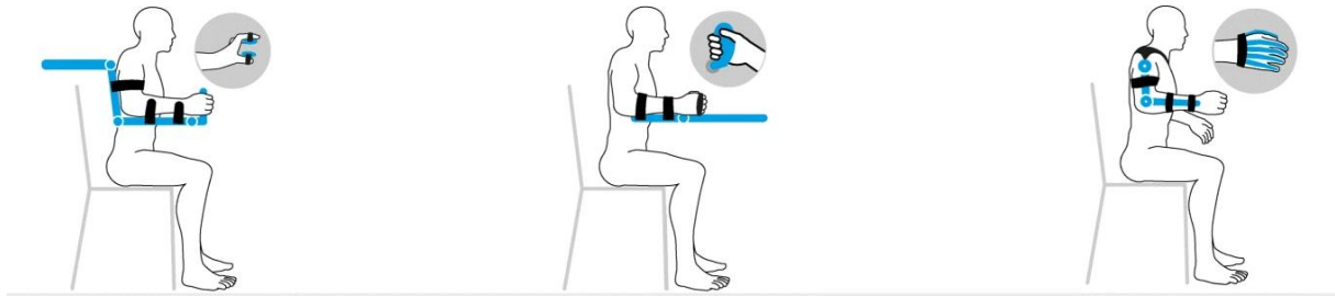
Slika 1. Lijevo – uzemljeni egzoskelet; sredina – uzemljeni uređaj s krajnjim efektom; desno – nosivi egzoskelet (37).
