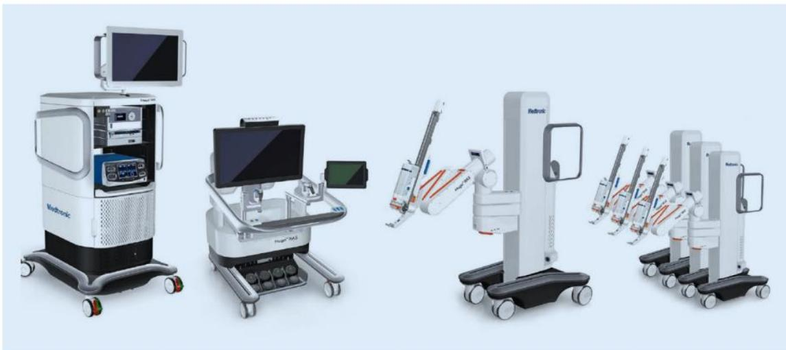
Slika 5. Hugo RAS robotski sustav. Pripremljeno prema (51)
