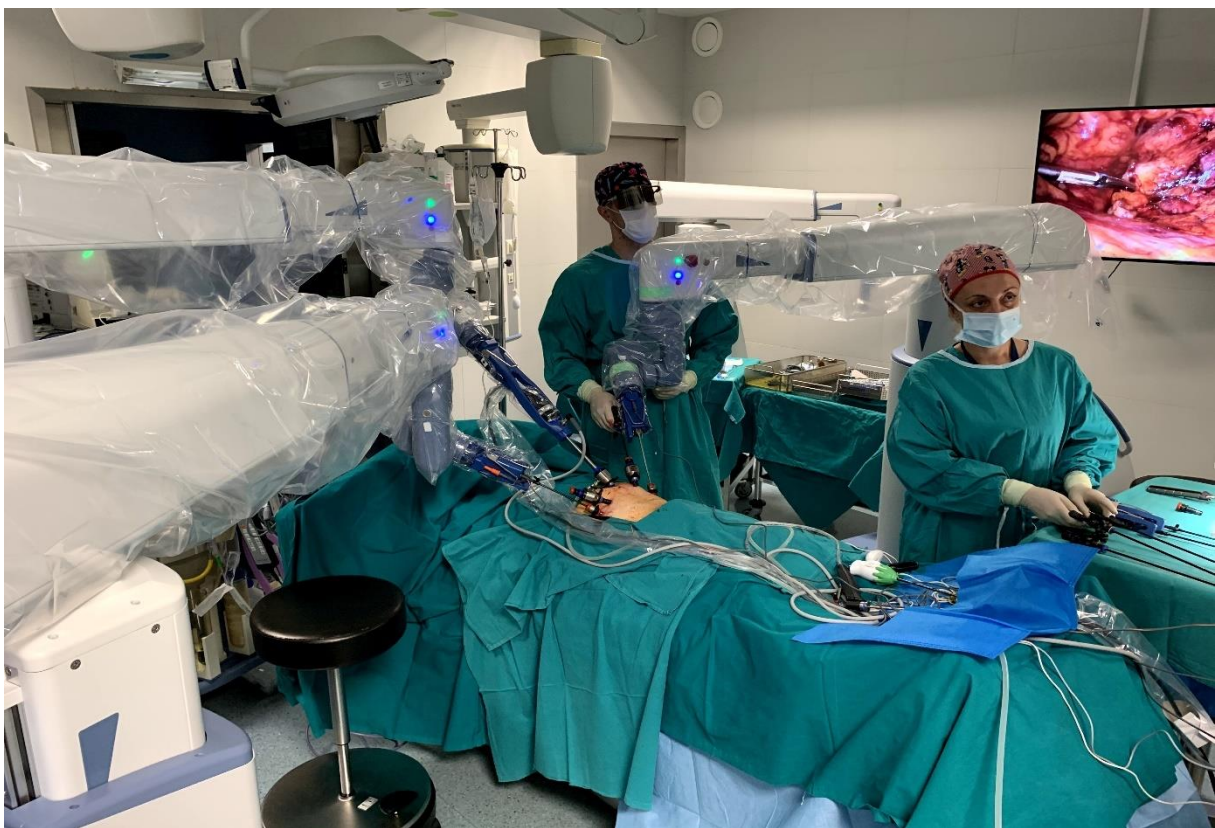
Slika 4. Izvođenje kirurškog zahvata (radikalna prostatektomija) robotskim rukama Senhance robotskog sustava na koje su spojeni endoskop i kirurški instrumenti u prisutnosti članova tima (arhiva Klinike za urologiju KBC-a Zagreb)
