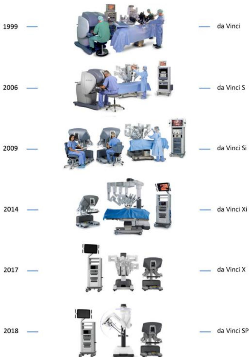
Slika 2. Šest modela da Vinci kirurškog sustava. Pripremljeno prema (9)
