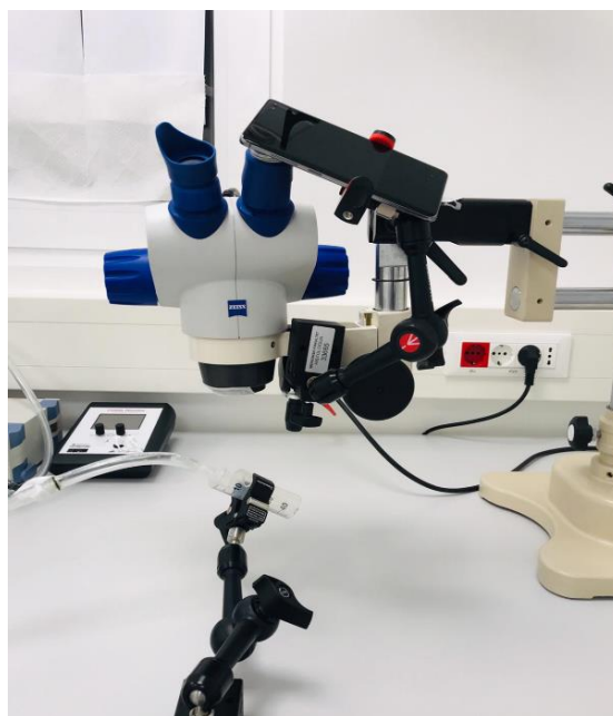
Slika 5. Operacijski mikroskop pretvoren u platformu za fotografiju i fluoresceinsku angiografiju očne pozadine.
