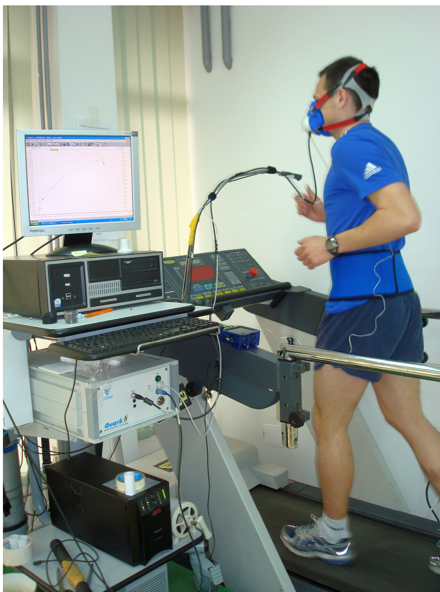
Slika 4. Prikaz ispitanika na pokretnoj traci sa sustavom za mjerenje spiroergometrijskih parametara i sustavom za mjerenje temperature
