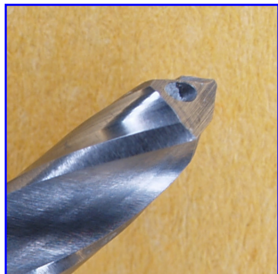
Slika 59. Oštrica prvog stupnja dvostupnjevanog spiralnog svrdla promjera 2.5-3.4 mm nakon 180 bušenja
