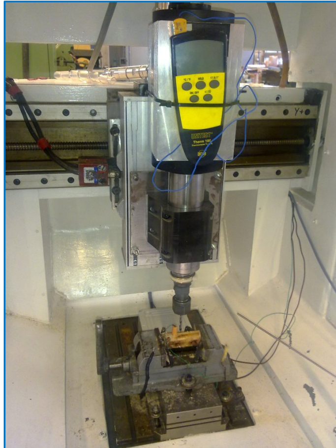
Slika 46. Prikaz izvođenja pokusa glodalicom Flexmatic FA 530 S
