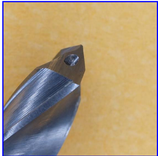
Slika 57. Oštrica spiralnog svrdla promjera 4.5 mm nakon 180 bušenja
