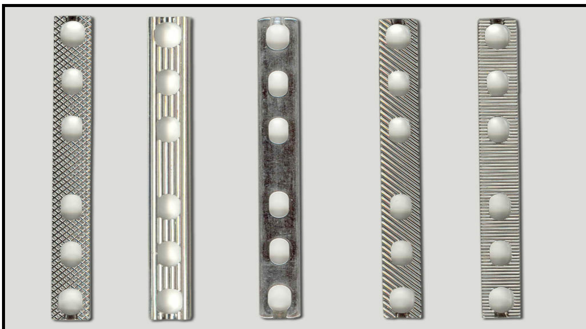
Slika 32. Izgled novo konstruiranih i standardne Müller pločice sa šest ovalnih otvora
