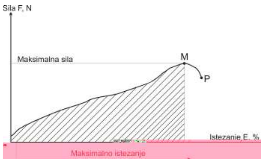
Slika 13. Prikaz izvršenog rada (osjenčana površina) do maksimalnog porasta sile na krivulji sila-istezanje
