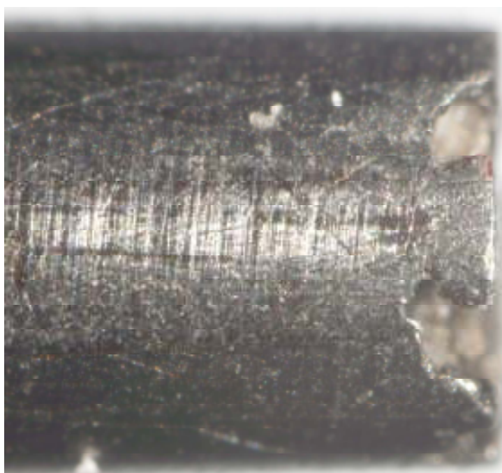
Slika 5.2. Oštećenje kavitacijom ultrazvučne kontaktne sonde.
