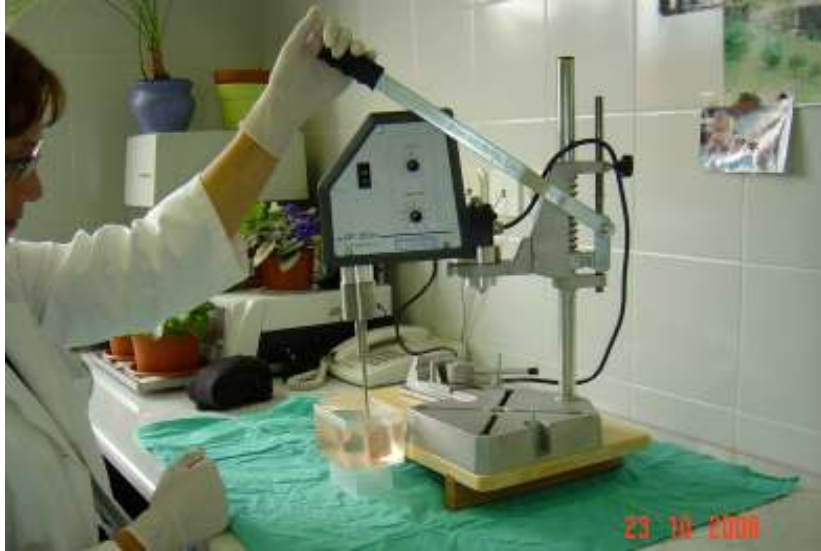
Slika 3.12. Nosač bušilice (Wolfcraft GmbH, D-56746 Kempenich, Germany) koji je ovom prilikom poslužio kao držač ultrazvučnog generatora UP 200s, dr. Hielscher, GmbH.
