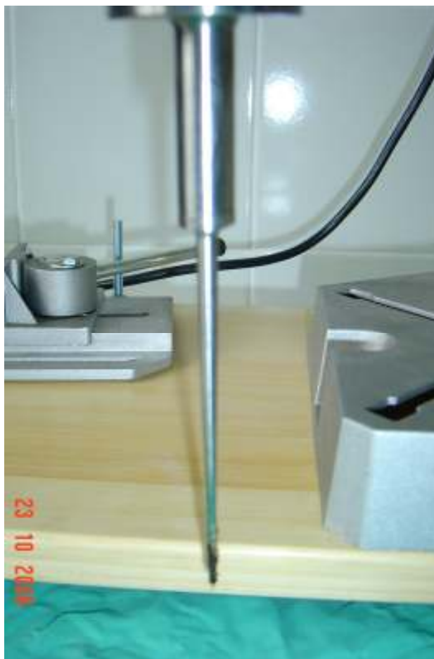
Slika 3.10. Titanski nastavak kojim je aplicirana ultrazvučna energija na diskalno tkivo s ostacima diskalnog koaguliranog tkiva na vršku sonde uslijed termalnog učinka
