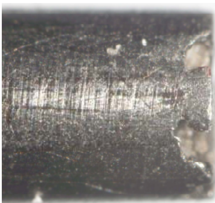
Slika 5.2. Oštećenje kavitacijom ultrazvučne kontaktne sonde.
