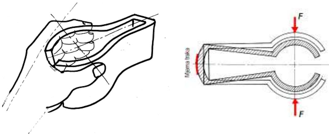
**Slika 55.** Prikaz uređaja za mjerjenje zahvatne sile, s uvećanom deformacijom aparata koji se deformira na takav način da se prednja ploha uređaja savija kako je označeno s tim da je na nju bila nalijepljena mjerna traka. Muftić O. ref. 118.
