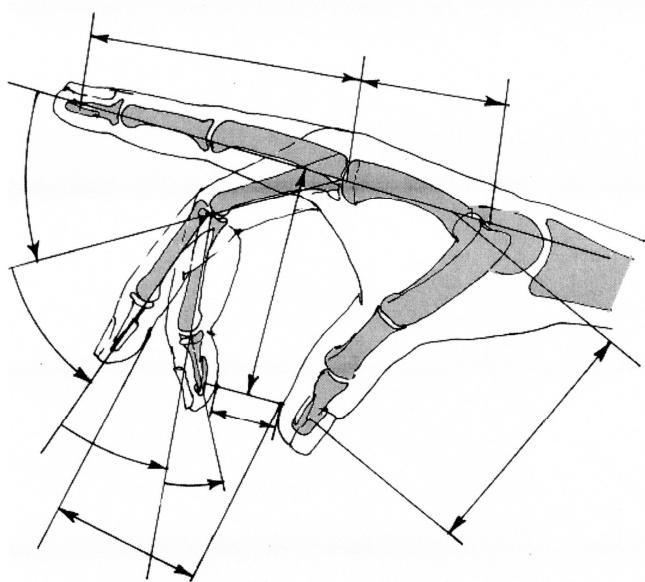
Slika 40. Zatvoreni kinematički lanac.
