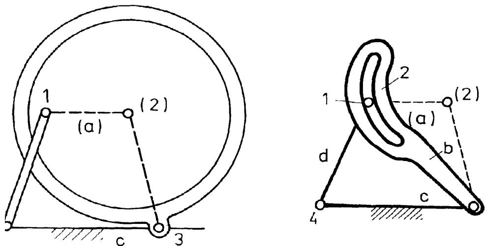
Slika 17. Kinematički ekvivalent nastao ekspanzijom rotoida. ref. 69.
