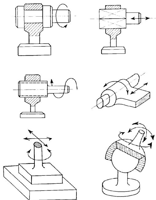
Za ostvarivanje dodira među članovima kinematičkih parova potrebno je da budu zatvoreni. Zatvaranje kinematičkih parova može biti kinematičko ili dinamičko. Kinematičko se zatvaranje obavlja putem oblika ili dizajna veze kinematičkog para, dok se dinamičko ostvaruje pomoću vanjskih sila (težina, opruge, centrifugalne sile i slično) <sup>69</sup>.
