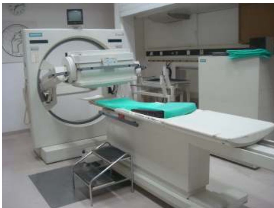
Slika 3. Gamma kamera Siemens Diacam s detektorom širokog pravokutnog vidnog polja korištena za scintigrafsko prikazivanje glave, vrata i prsnog koša, te cijelog tijela bolesnika.
