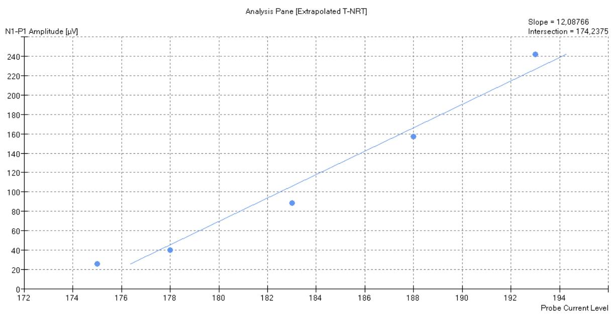
Slika 6. Procijenjeni prag ECAP-a (*intersection*) i nagib krivulje prirasta amplitude (*slope*) mjereni T-NRT metodom. Na apscisi je intenzitet podražaja. Na ordinati su amplitude ECAP-a, mjereno od N1-P1. Snimka ekrana, vlastito mjerjenje.
