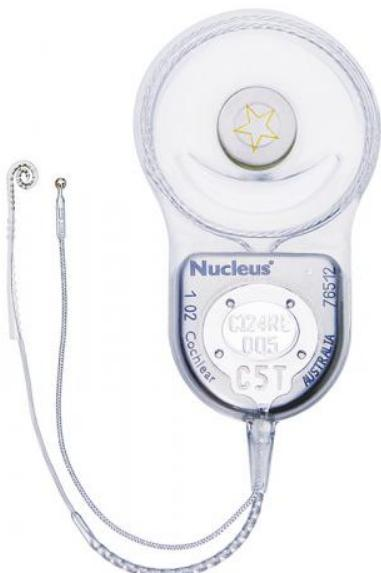
Slika 2. Nucleus Freedom CI24RE s Contour Advance elektrodom (preformirana elektroda koja već ima oblik pužnice). Druga elektroda koja završava s kuglicom je referentna elektroda.
