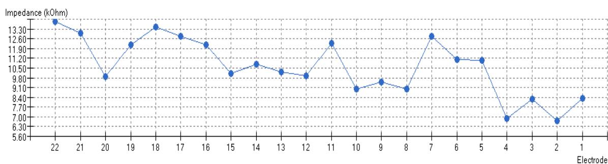
Slika 7. Grafički prikaz krivulje otpora nastale spajanjem vrijednosti na pojedinim elektrodama. Na apscisi electrode od broja 22 do 1. Na ordinati električni otpor. Mjerjenje u modalitetu "Common Ground". Snimka ekrana, vlastito mjerjenje.
