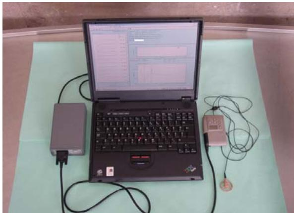
Slika 8. Prijenosno računalo s međusučeljem (lijevo) i govornim procesorom, kabelom i antenom (desno).
