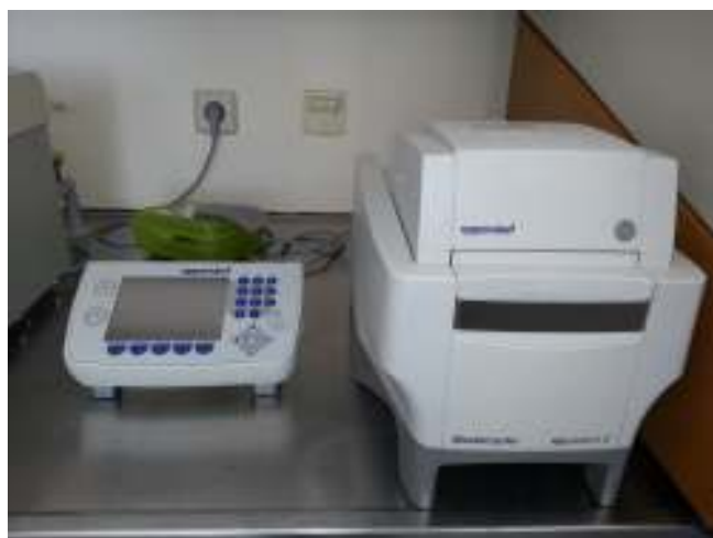
Slika 4.8 Instrument Eppendorf EP Gradient S PCR
