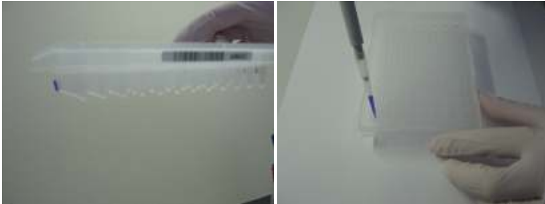
Slika 4.7 Ploča sa 96 bazena za uzorke
