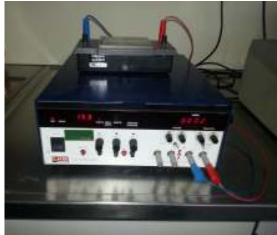
Slika 4.10 Baterija i kupelj za EF
