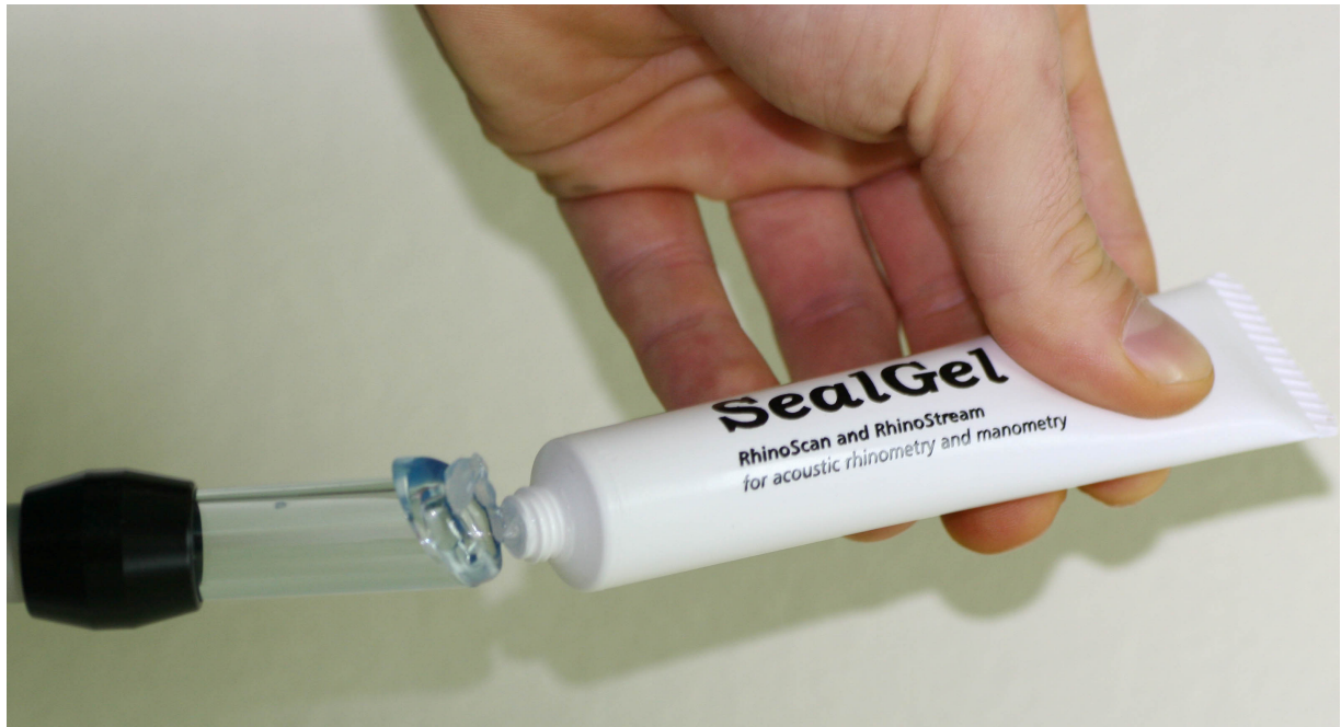
Slika 14. Nanošenje gela za akustičko brtvljenje na slobodni kraj anatomskog nosnog adaptora
