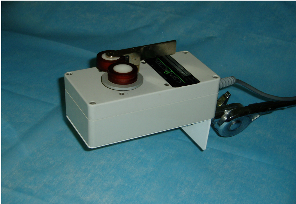
Slika 4. Sprava za izvlačenje katetera
