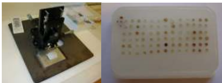
Slika 7. TMA mape (gore), tkivni manualni arrayer (dolje lijevo), TMA kocka (dolje desno)
