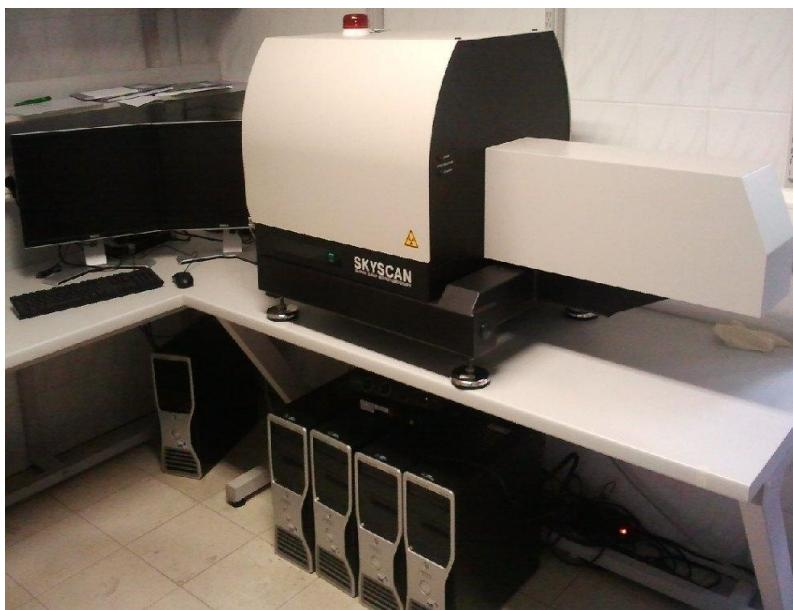
**Slika 5.**  $\mu\text{CT}$  uređaj 1076 SkyScan. Konstrukcija uređaja omogućava *in vivo* kao i *ex vivo* snimanje uzoraka.
