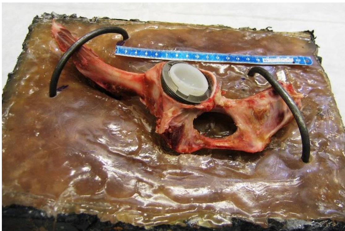
Slika 21. Zdjelica fiksirana na posebno izrađeni držač.
