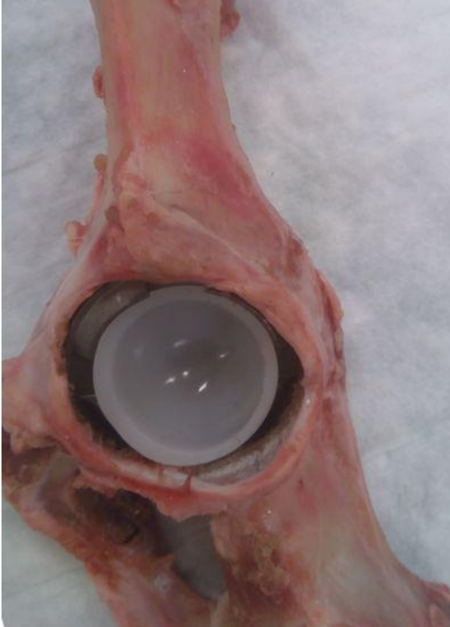
Slika 23. Pomak acetabularne komponente u dubinu uslijed opterećenja.
