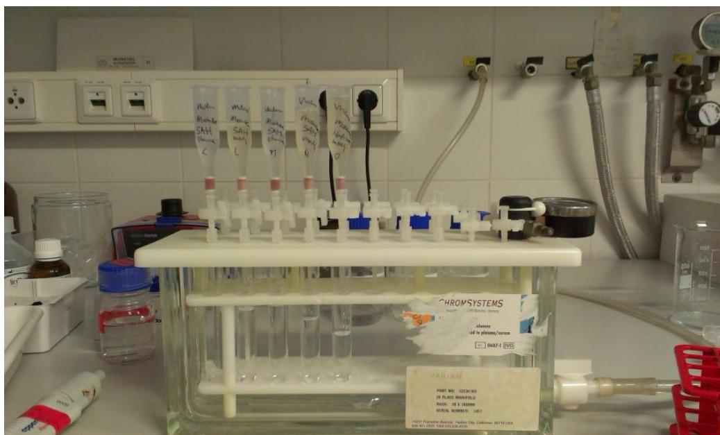
Slika 10. Vakuum sustav za izdvajanje AdoMet i AdoHcy s kolonama za ekstrakciju.
