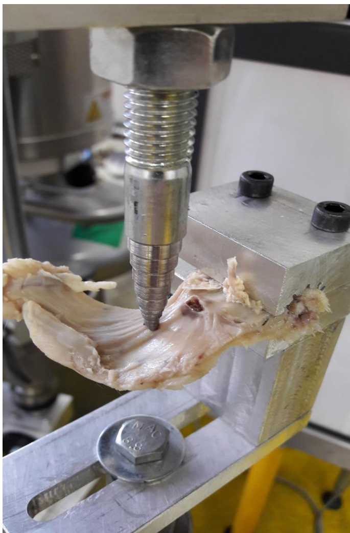
Slika 36. Prijelom rebra na mjestu frakturne pukotine tijekom biomehaničkog testiranja.
